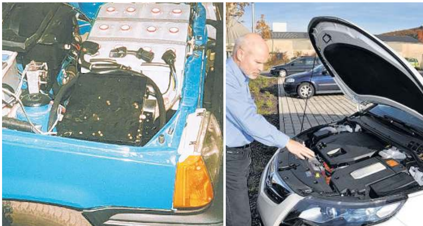
Selbst ist der Mann. So wurde 1993 ein Seat Marbella (Fiat Punto) kurzerhand zum Elektroauto umgebaut (links). Das Innenleben des Ampera hingegen stellt auch den Profi vor eine Herausforderung (rechts).
